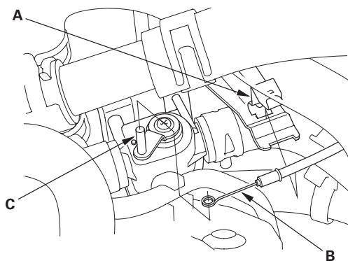
2. 从仪表板下，将加热器阀拉线壳体从拉线卡夹 (A) 上断开，并将加热器阀拉线 (B) 从驾驶员侧空气混合控制连杆 (C) 上断开。
